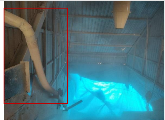
ท่อดูดฝุ่นจากผ้าใบเรือเข้าสู่เครื่องดับฝุ่นบริเวณโรงกลั่นค้ำ A
