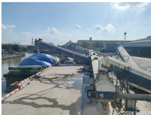
รูปที่ 2-27 การขนถ่ายสินค้าบริเวณโรงกลั่นค้ำ B และสายพานลำเลียงมันเส้นเข้าซึ่งเป็นระบบปิด
