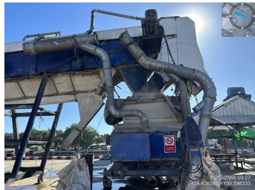
รูปที่ 2-8 เครื่องดักจับฝุ่น ติดกับโรงกลั่นค้ำ B พร้อมท่อดูดฝุ่นจากสายพานลำเลียงมันเส้น
